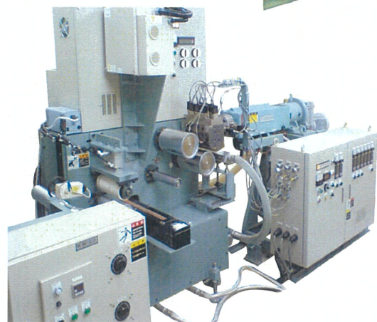
●GM25-28押出機+T200フィルム検査装置
