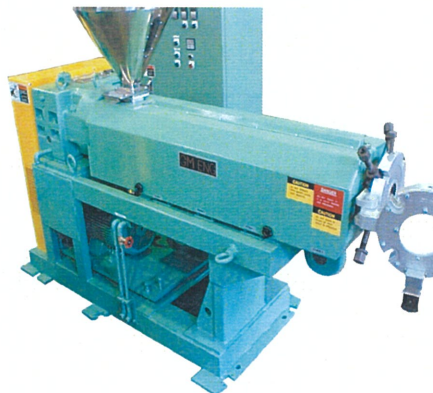
●オーバーホール後の押出機
